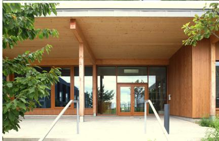
Les matériaux biosourcés, en particulier le bois, occupent une large place en intérieur comme en extérieur (plancher, poutre, ossature des façades, bardage du rez-de-chaussée, plafonds en fibre de bois). Les autres matériaux (menuiseries aluminium, bardage en alu ou zinc) sont pour leur part facilement recyclables.
